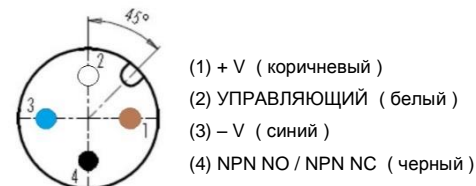
Датчик с разъемом M12, 4-pin, штекер "папа", NPN NO / NC выход
