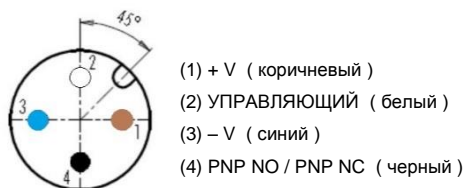
Датчик с разъемом M12, 4-pin, штекер "папа", PNP NO / NC выход
